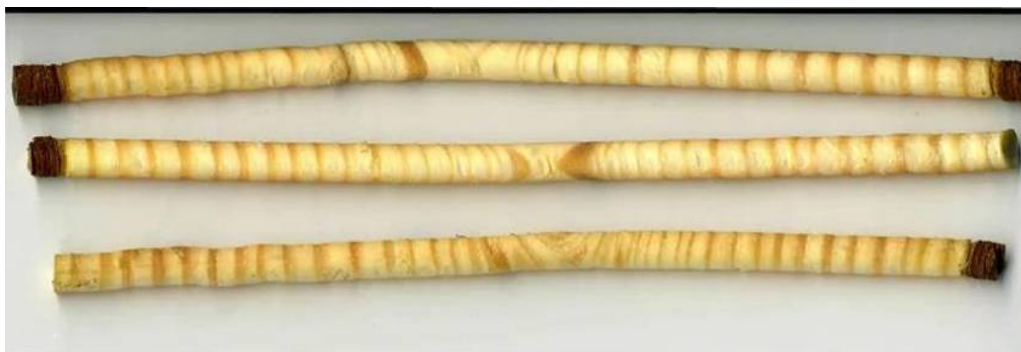
Рис. 15.4. Керны для определения возраста по годичным слоям
