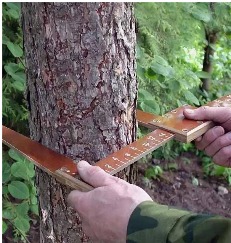
Рис. 15.1. Определение диаметра дерева с помощью мерной вилки: замер проводят на высоте 1.3 м (высота груди); мерная вилка должна быть плотно прижата к стволу и соприкасаться с ним в 3 точках
