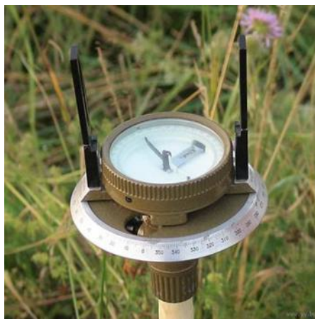
Рис. 13.4. Буссоль на вешке, готовая к работе
